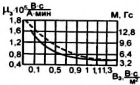
13.13-rasm. Tirqish magnit o'tkazuvchanligining induksiyadan bog'liqligi
