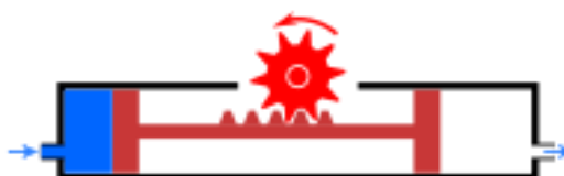
9.23-rasm. Reykali-tishli uzatmali aylanuvchi ikki tomonlama amal qiluvchi pnevmoyuritma sxemasi
