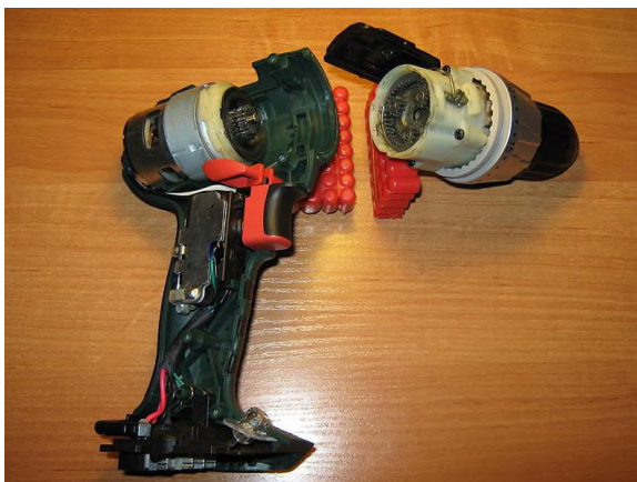
10.14-rasm. Planetar uzatmani drelda qo‘llanishi
