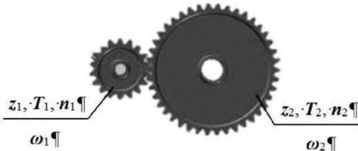
10.5-rasm. [ГОСТ 16530-83, ГОСТ 16531-83] bo‘yicha tishli uzatmalar parametrlarini belgilari
