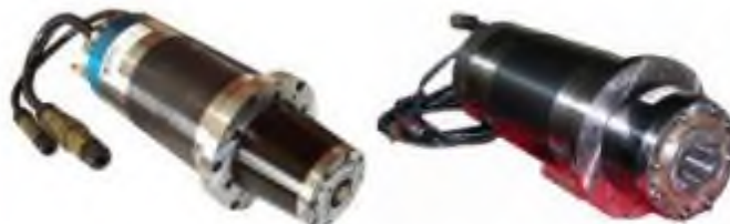
14.13-rasm. Raqamli dasturli boshqariladigan stanoklar uchun asbobni avtomatik almashtirish xususiyatiga ega elektroshpindellar
