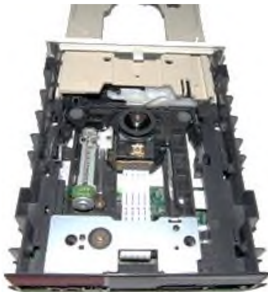
6.14-rasm. Kompakt-disklar yuritmasining ichki tuzilishi
