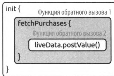
Рис. 6.2. Использование функций обратного вызова
