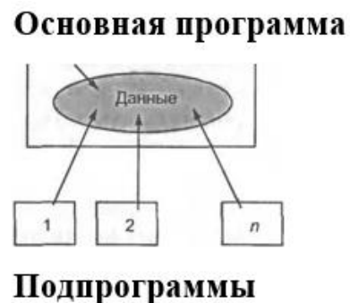
Рис. 1.2 - Архитектура программы с глобальной областью данных
