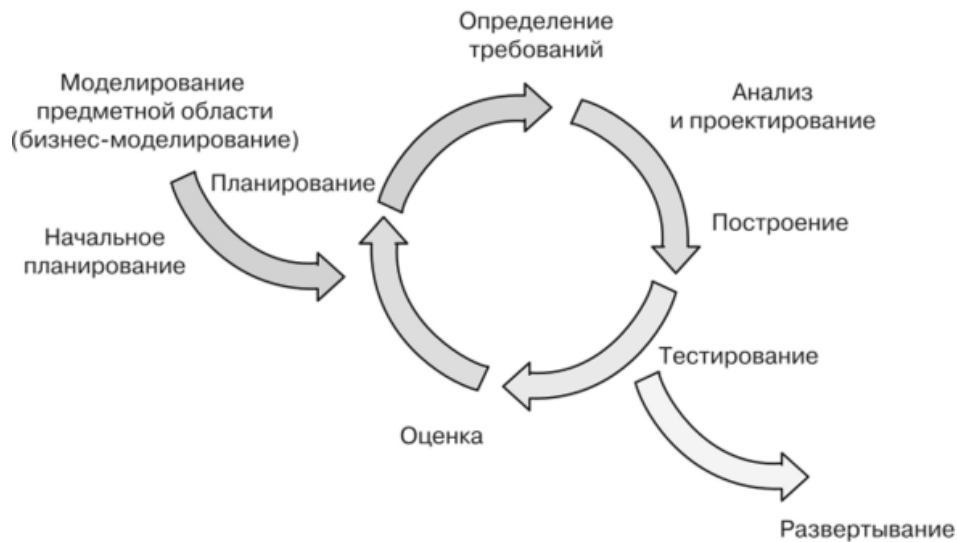
Рис. 3.7 – Схема применения методологии проектирования RUP
