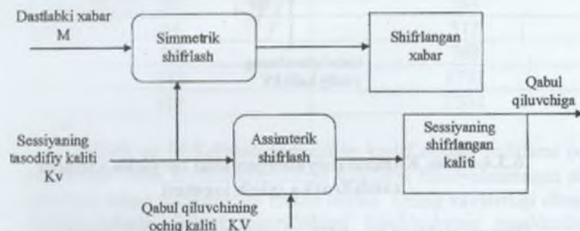
6.3.3-rasm. Kombinatsiyalangan usul bo'yicha xabarni shifrlash sxemasi.
