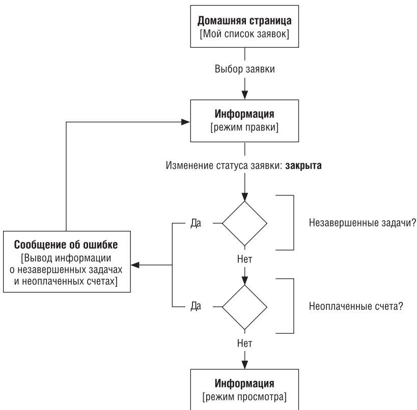
Рис. 10.17. Диаграмма потоков задач показывает, какую информацию система покажет пользователю в зависимости от различных условий
