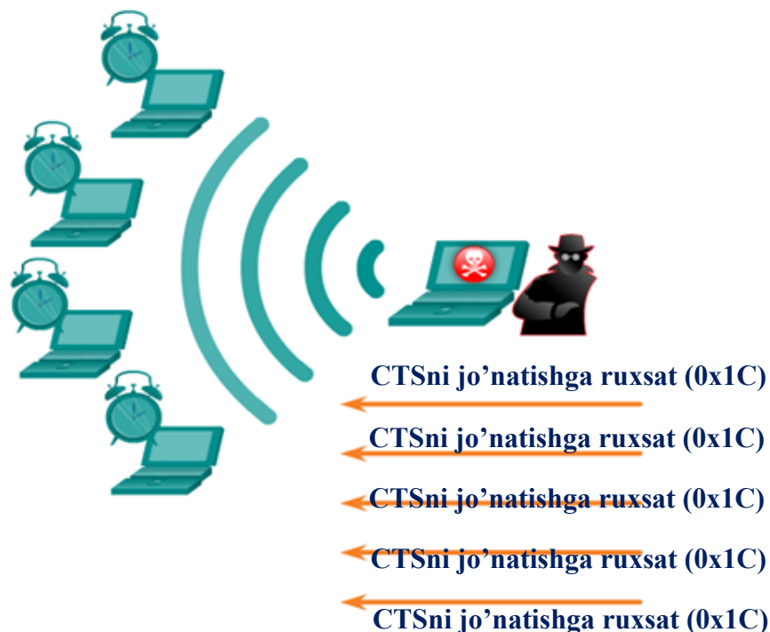
4.5- rasm. CTS kadrlarni jo‘natishga ruxsat etishlar ko‘chkisimon DOS hujumini hosil qiladigan g‘arazgo‘y
