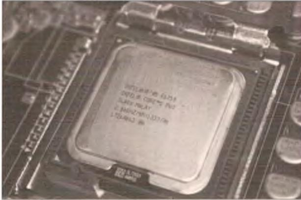
**РИС. 29.2.** Многоядерный микропроцессор Intel
