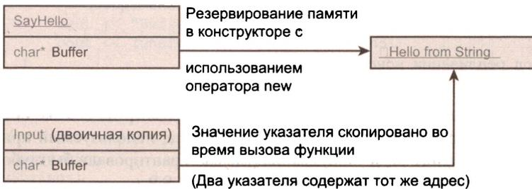
**Рис. 9.3.** Поверхностное копирование объекта `SayHello` в параметр `Input` при вызове функции `UseMyString()`
