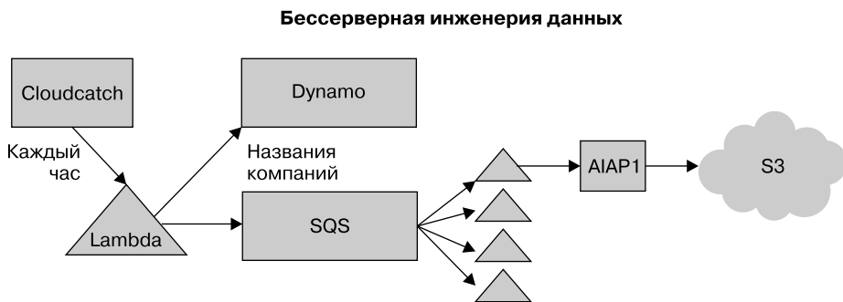
Рис. 15.7. Бессерверный конвейер данных
