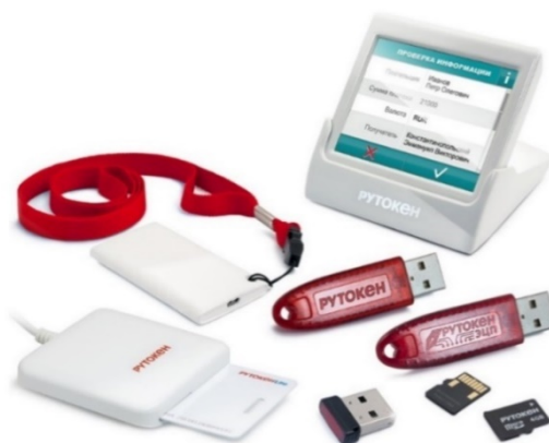
3.11-rasm. Turli ko'rinishdagi ruToken USB shifrator qurilmasi
