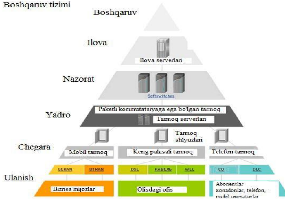
1.3 - rasm. NGN tarmog'ining boshqaruv tizimi
