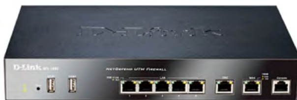
17-rasm. SOH tarmoqlari uchun DFL-260E – tarmoqlararo ekrani.
