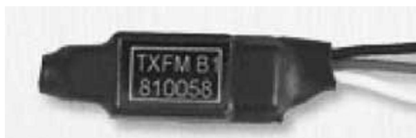
10-rasm. Oddiy ko‘rinishdagi radioo‘rnashma.
