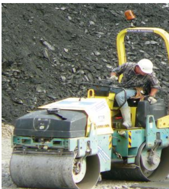
3.2-rasm. Insonga umumiy tebranish hosil qiluvchi mexanizmlar. 22
