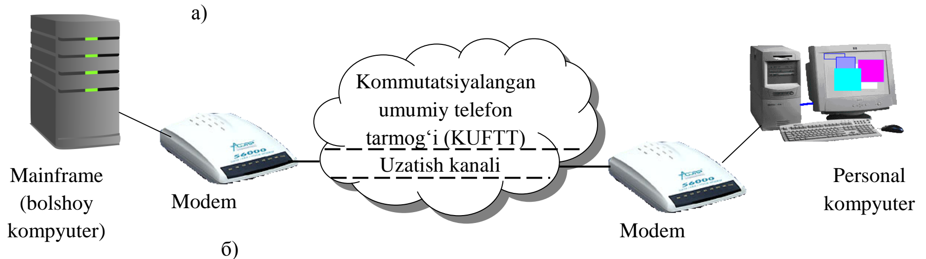
5.14-rasm. Ma'lumot uzatish tizimini na'munali tuzilishi: a) ma'lumot uzatish tizimi blok sxemasi; b) ma'lumot uzatish tizimini mavjud sxemasi
