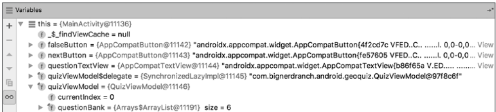
Рис. 5.8. Проверка значений переменных во время выполнения
