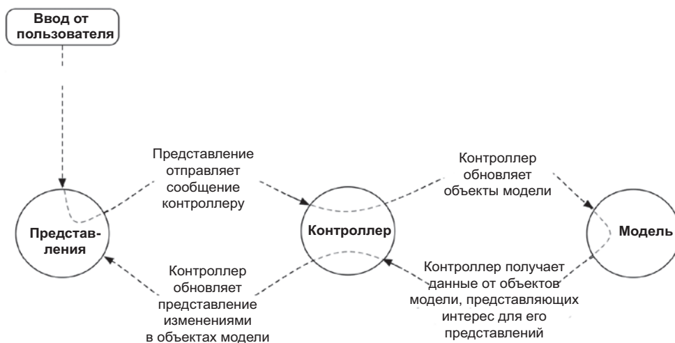
Рис. 2.4. Взаимодействия MVC при получении ввода от пользователя
