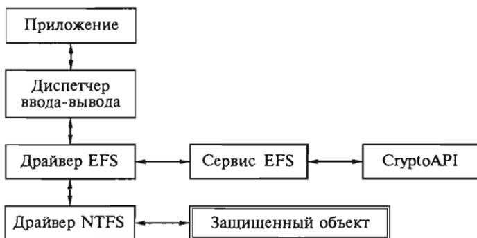
Рис. 5.17. Компоненты шифрующей файловой системы Windows
