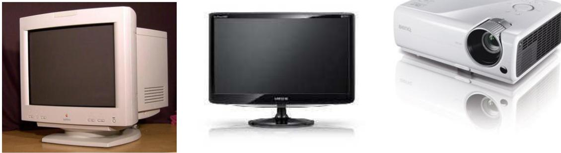
Рис. 5.17. Типы мониторов ЭЛТ, ЖК, проекционный
