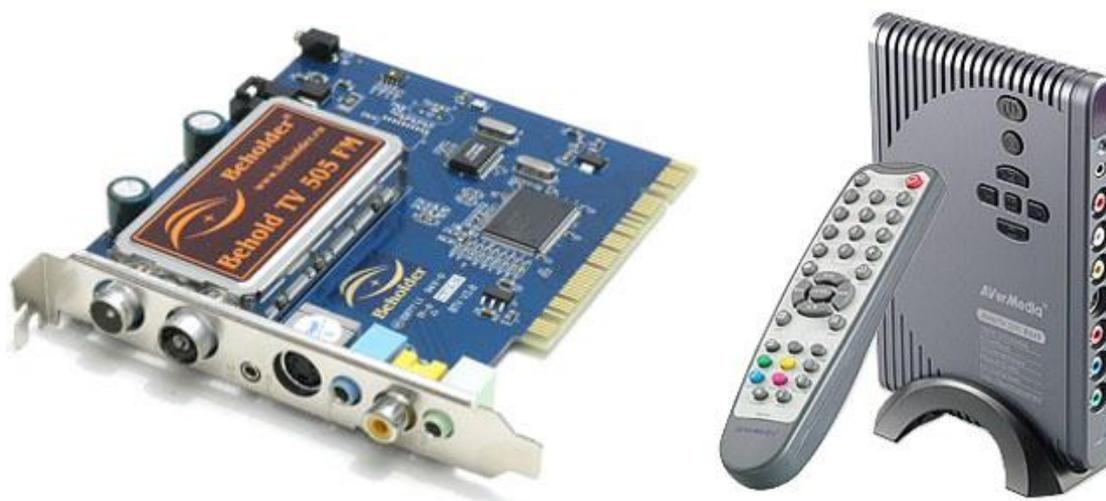
Рис. 5.20. Типы видеотюнеров – встроенный, внешний
