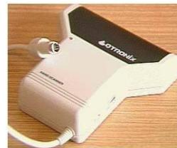
Рис. 5.11. Ручной сканер
