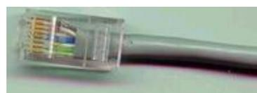
Рис. 6.6. Кабель «витая пара» с коннектором
