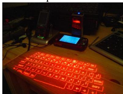
Рис. 5.8. Проекционная клавиатура
