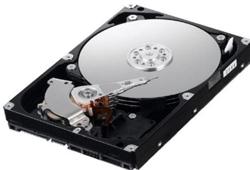
Рис. 5.5. Жесткий диск без крышки
