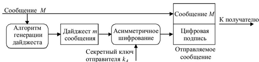
Рис.3.19. Схема формирования электронной цифровой подписи
