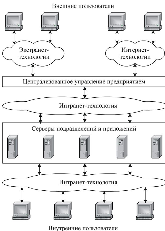
Рис.6.1. Структурная схема корпоративной информационной системы
