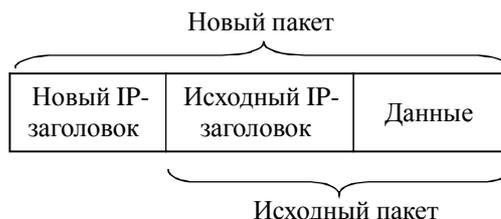
Рис.10.2. Пример пакета, подготовленного для туннелирования
