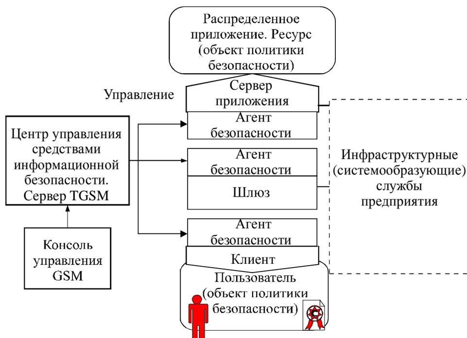
Рис.11.3. Общая структурная схема системы управления средствами информационной безопасности
