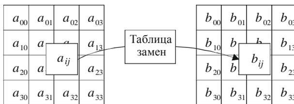
Рис.3.8. Преобразование BS (ByteSub) использует таблицу замен (подстановок) для обработки каждого байта массива State
