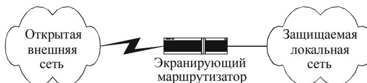
Рис.9.4. Межсетевой экран - экранирующий маршрутизатор
