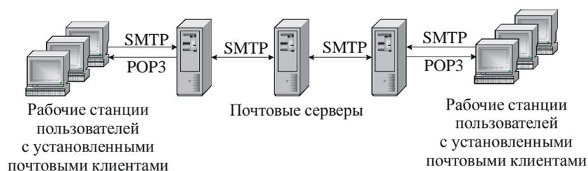
Рис.5.2. Обобщенная архитектура электронной почтовой системы
