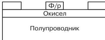
Рис. 1.16. Вытравливание незасвеченного фоторезиста
