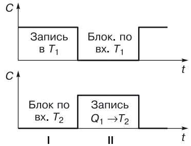
Рис. 14.29. Описание работы двухтактного триггера
