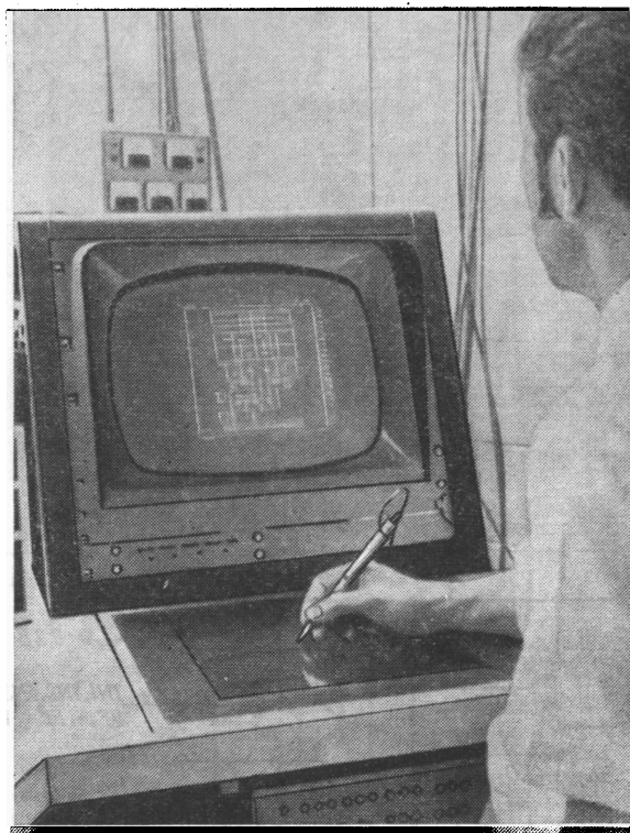
Фиг. 8.44. Изготовление маски с помощью ЦВМ типа ТХ-2 и соответствующей программы, взаимодействующей с графическим терминалом.
