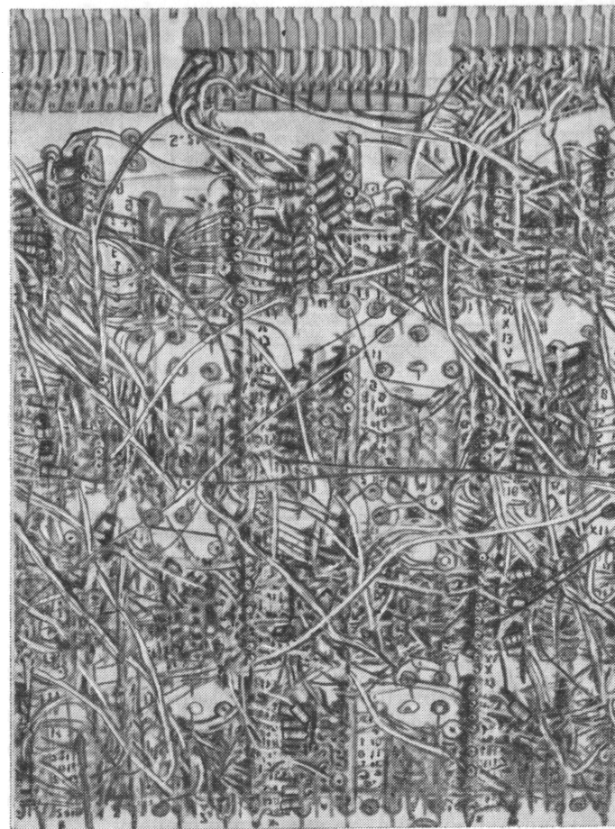
Фиг. 8.3. Плата со стороны монтажа, выполненного накруткой (крупный план).
