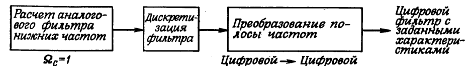
Фиг. 4.32. Частотные преобразования фильтров нижних частот.
