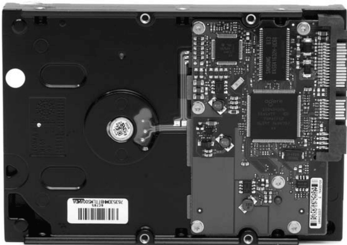
Рис. 2.2. Плата электроники винчестера
