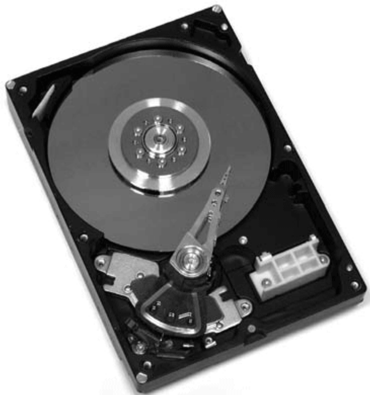
Рис. 2.1. Гермоблок со снятой крышкой
