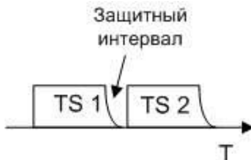
Рис. 1.9. Защитные интервалы в цикле TDMA
