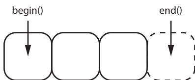
Рис. 13.1. Полуоткрытый диапазон в массиве из трех элементов
