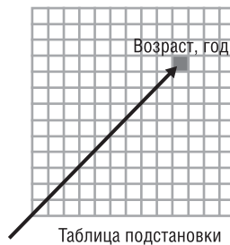
Рис. 18-1. Как следует из ее имени, таблица с прямым доступом позволяет обращаться к требуемому элементу напрямую
