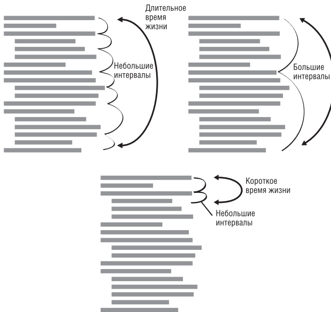
Рис. 10-1. «Длительное время жизни» подразумевает, что переменная используется в крупном фрагменте кода. При «коротком времени жизни» переменная используется лишь в небольшом фрагменте. «Интервал между обращениями» к переменной характеризует, насколько тесно сгруппированы обращения к переменной
