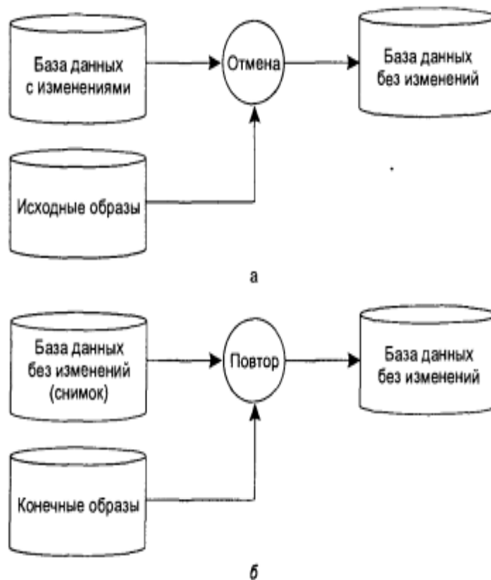
Рис. 12.1. Откат и накат транзакций: а – отмена изменений в базе данных (откат); б – повторное выполнение изменений (накат).
