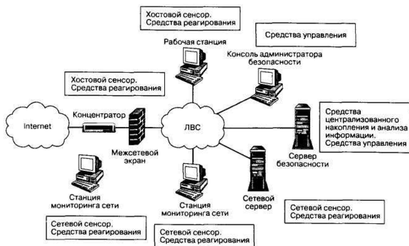
Рис. 7.1. Типовая архитектура системы выявления атак
