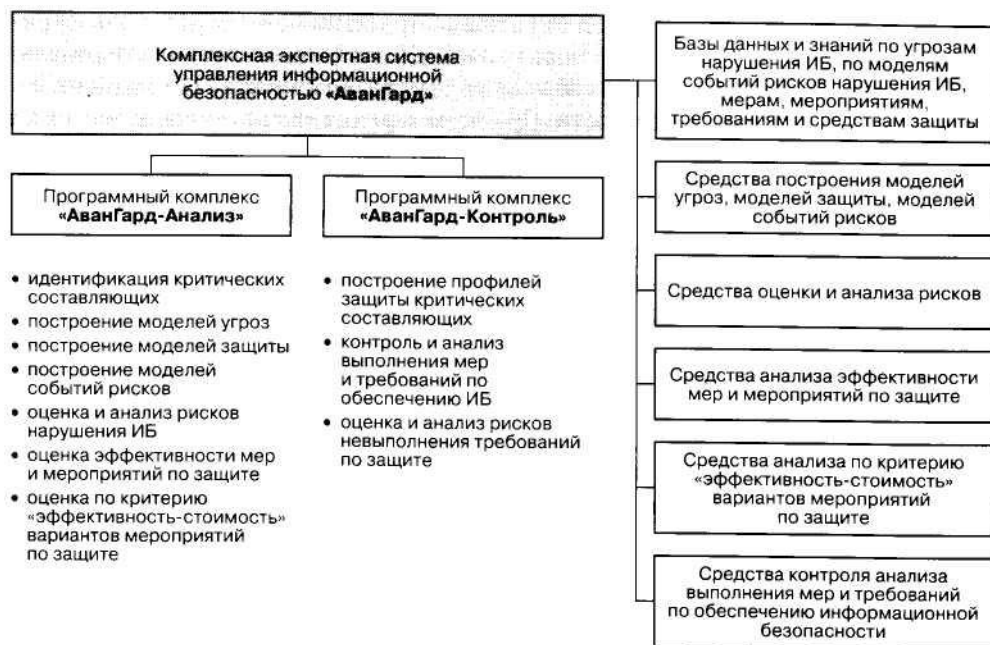
Рис. 4.16. Структура и функции ПО «АванГард»
