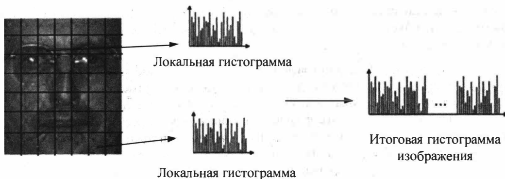
Рис. 8.21. Оцифровка фотографии с использованием локальных бинарных шаблонов изображения
