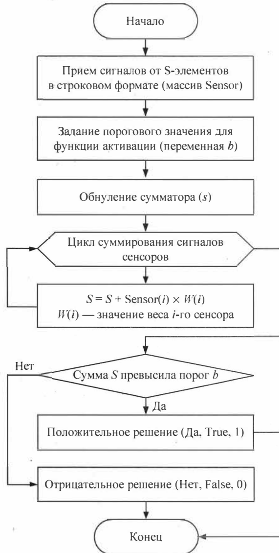
Рис. 4.9. Блок-схема алгоритма работы программы, моделирующей персептрон
