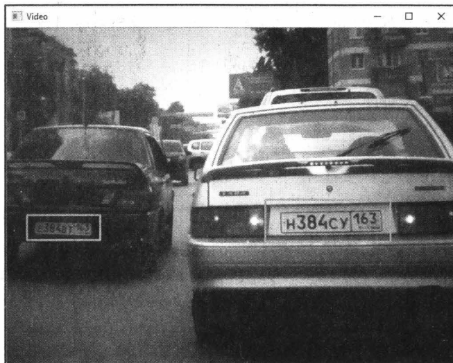
Рис. 8.9. Изображение, обработанное программой распознавания автомобильных номеров с видеокamеры
