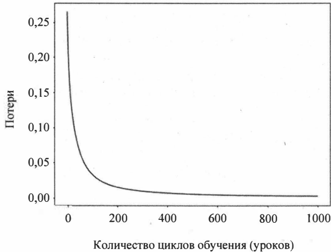
Рис. 5.13. Зависимость ошибочности решений нейронной сети от количества циклов обучения
