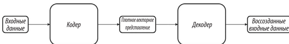
Рис. 6.4. Архитектура автокодера пытается вместить входные данные высокой размерности в плотное векторное представление, а затем использует это представление для того, чтобы воссоздать входные данные
