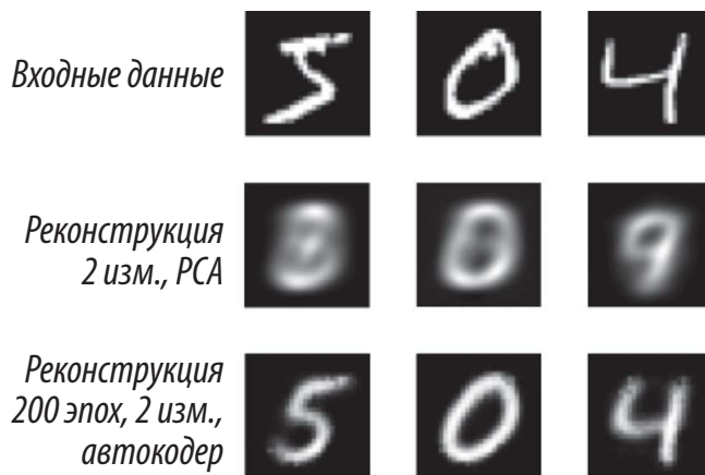
Рис. 6.10. Сравнение реконструкций метода главных компонент и автокодера
