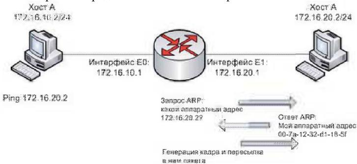
Кадр, сгенерированный интерфейсом Ethernet 1 маршрутизатора, имеет аппаратный адрес источника от интерфейса Ethernet 1 и аппаратный адрес назначения для сетевого адаптера хоста В. Важно отметить, что, несмотря на изменения аппаратных адресов источника и назначения, в каждом передаваемом пакете интерфейсе маршрутизатора, IP-адреса источника и назначения никогда не изменяются. Пакет никоим образом не модифицируется, но меняются кадры.
