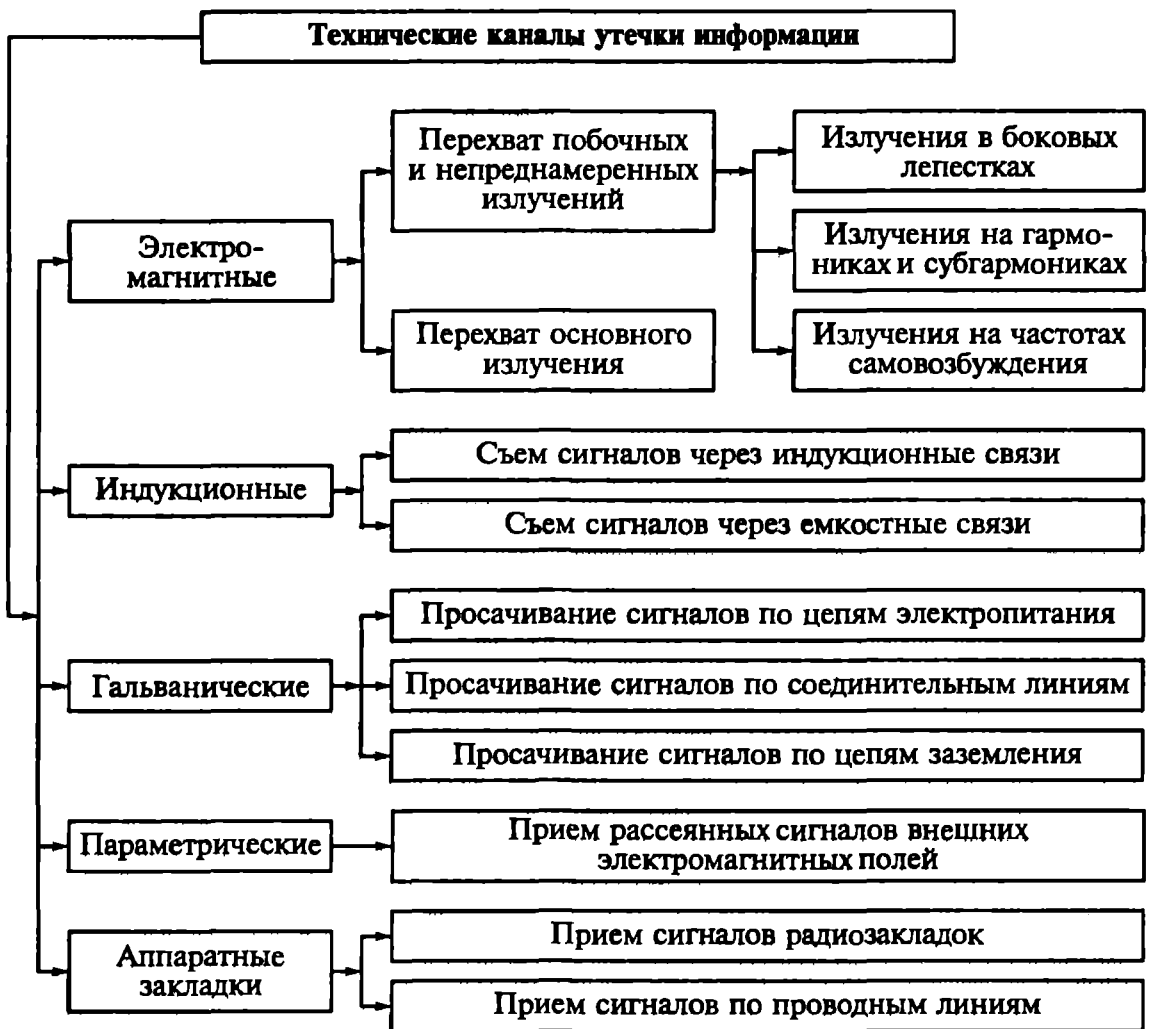
Рис. 3.3. Классификация технических каналов утечки информации
