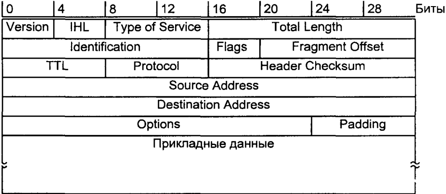
Рис. 6.6. Заголовок IP-датаграммы
