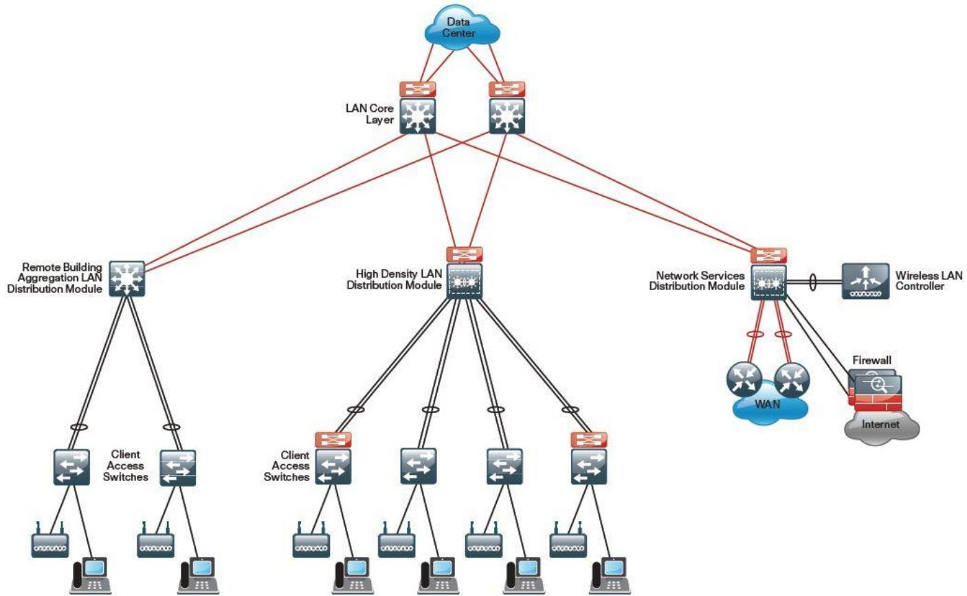
Рис. 2.13. Пример использования Уровня Ядра (LAN Core Layer)
