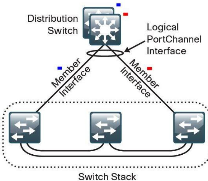
Рис. 2.7. Объединение портов стека коммутаторов в один PortChannel
