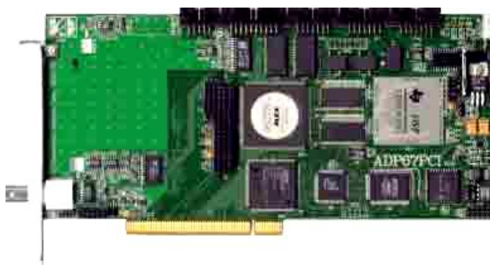
Рис. П.5. Процессорный модуль ADP6701PCI компании Инструментальные системы на базе ПЦОС TMS320C6701
