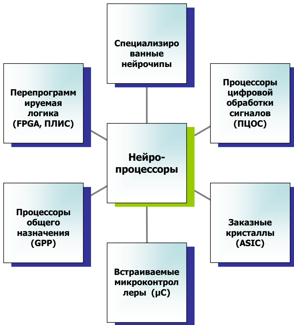
Рис. 4.1. Кристаллы, используемые в качестве нейропроцессоров
