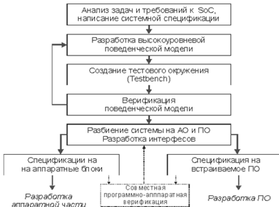
Рис.22 - Маршрут системного проектирования SoC
