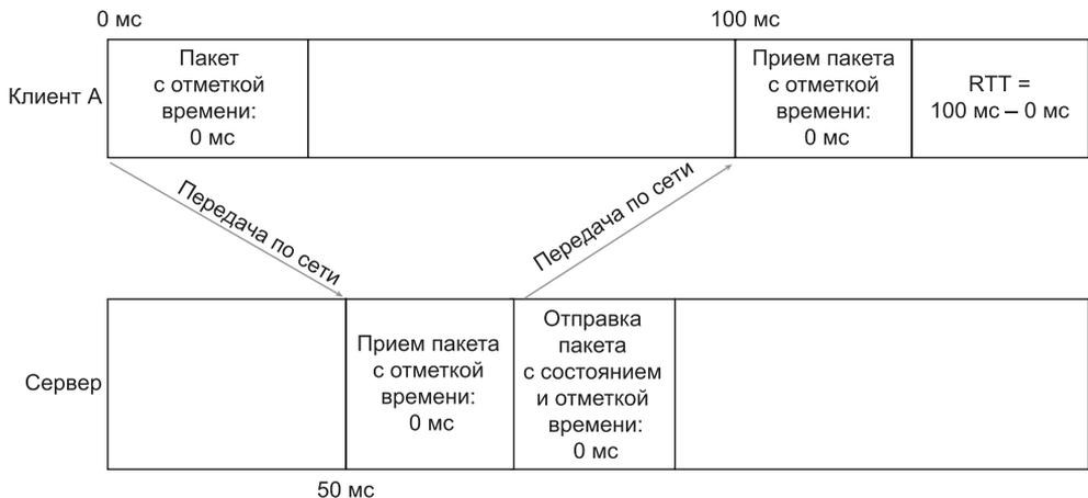
Рис. 8.4. Определение периода RTT
