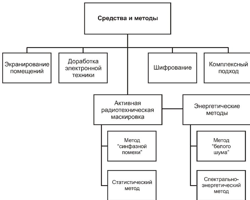
**Рис. 11.2.** Способы и методыЗИ, обрабатываемые средствами электронной техники, от утечки по радиотехническому каналу
