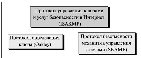
**Рис. 18.15.** Компоненты протокола управления ключами в Интернете
