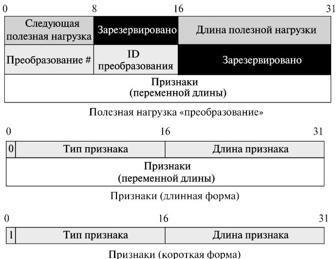
**Рис. 18.33.** Полезная нагрузка «Преобразование»
