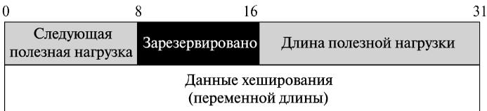
Рис. 18.38. Полезная нагрузка «Хэширование»
