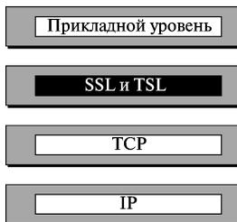
**Рис. 17.1.** Место SSL и TSL в модели Интернет
