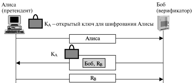
Рис. 14.9. Односторонняя система проверки подлинности с асимметричным ключом
