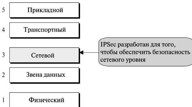
Рис. 18.1. Набор протоколов TCP/IP и IPSec
