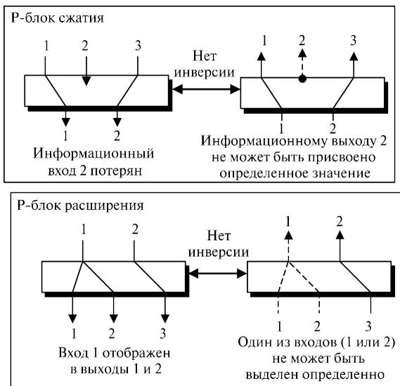
ча, чтобы восстановить отброшенный бит. В Р-блоке расширения вход в процессе шифрования может быть отображен более чем в один выход; алгоритм дешифрования не имеет ключа и не определяет, тем самым, какие из нескольких входов отображены в данном выходе. Рисунок 5.7 демонстрирует оба случая.
