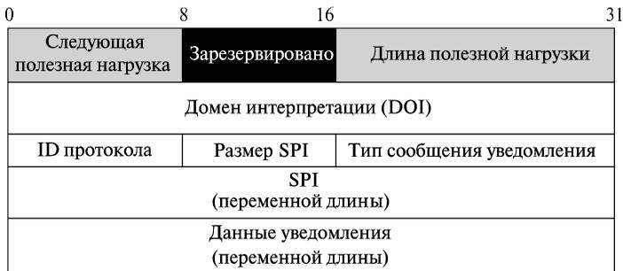
**Рис. 18.41.** Полезная нагрузка «Уведомление»
