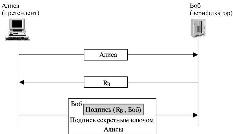
**Рис. 14.11.** Одностороннее установление подлинности с помощью цифровой подписи
