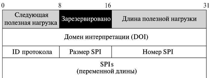
SA's больше не поддерживает. Рисунок 18.42 показывает формат полезной нагрузки «удаление».
