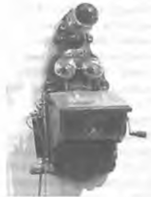
Рис. 1.8. Настенный телефонный аппарат производства L.M. Ericsson & Co, Стокгольм [49]
