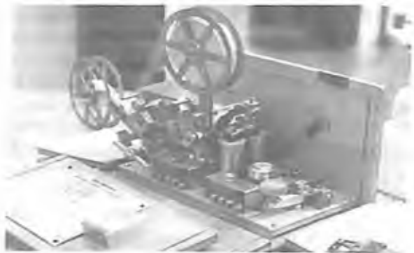
Рис. 1.4. Пишущий телеграфный аппарат Морзе, выпущенный заводами «Сименс и Гальске» в России [49]
