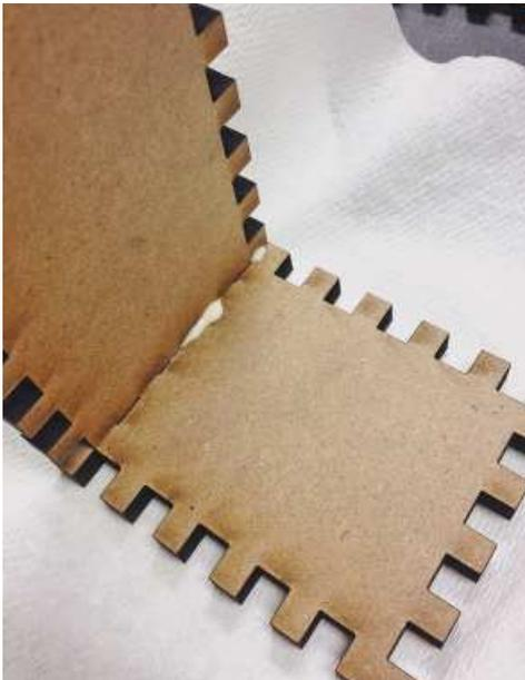
**Рис. 2.16.** Начните процесс сборки с приклеивания одной из сторон к основанию
