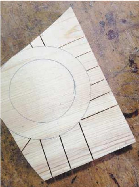
**Рис. 9.10.** Вырезаем круги с помощью ленточной пилы
