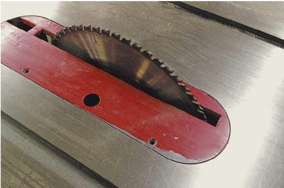
**Рис. 8.19.** Рабочая часть циркулярной пилы
