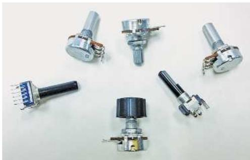
**Рис. 1.7.** Потенциометры позволяют управлять параметрами электрической цепи путем вращения регулятора
