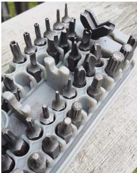
**Рис. 8.46.** Этот набор включает более 100 различных размеров и конфигураций наконечников к отвертке для откручивания винтов безопасности
