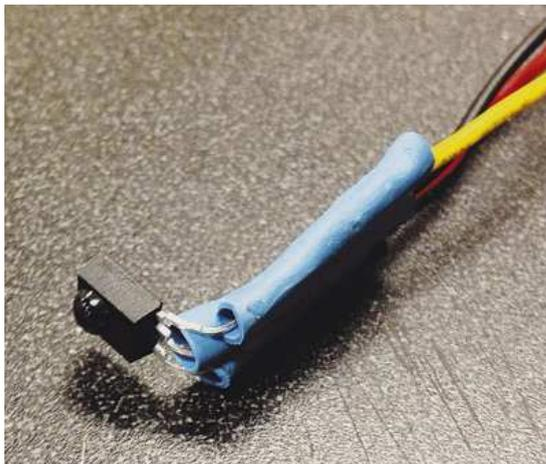
**Рис. 12.12.** ИК-датчик с припаянными проводами
