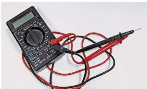
**Рис. 8.3.** Мультиметр DT-830B — это замечательный недорогой измерительный прибор
