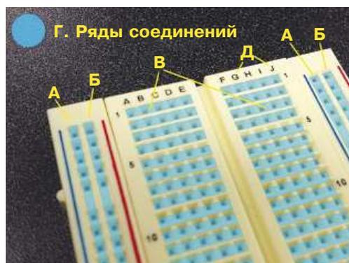
**Рис. 2.2.** Устройство стандартной макетной платы
