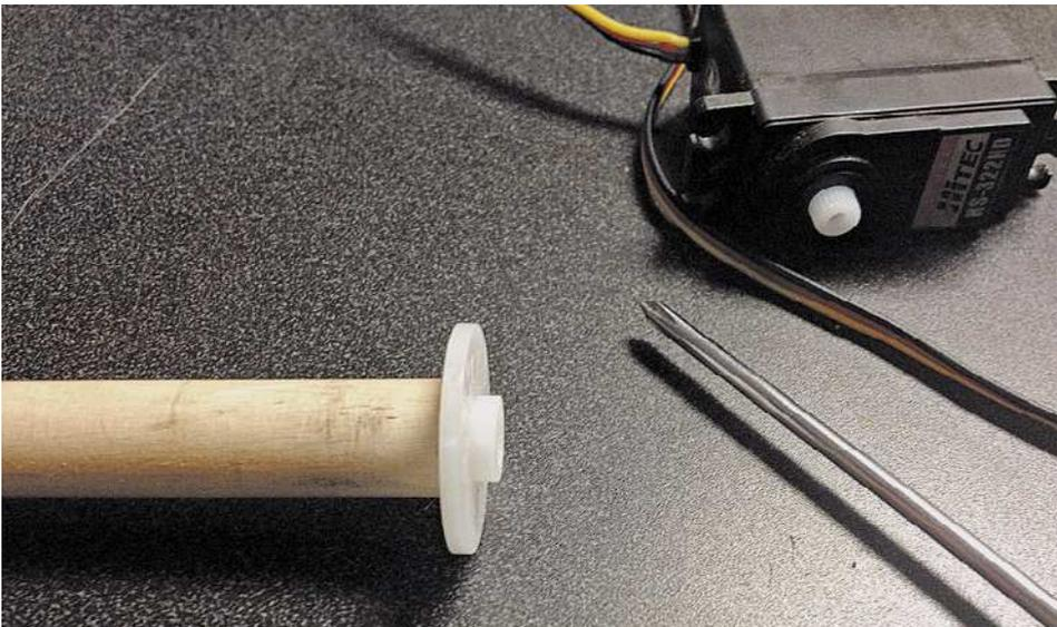
**Рис. 13.12.** Прикрепите сервонасадку с одного конца стержня
