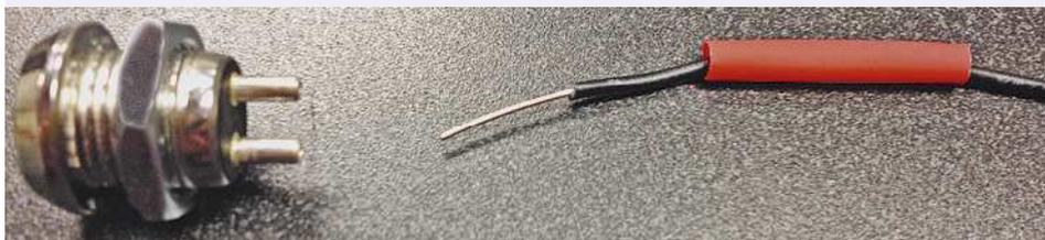
**Рис. 2.12.** Выводы замка-выключателя слишком гладкие, чтобы присоединить к ним провод, понадобится термоусаживаемая трубка
