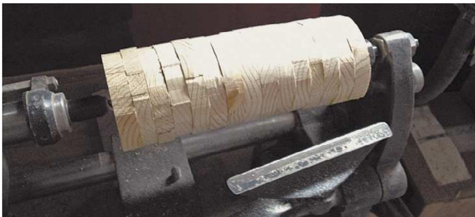
**Рис. 9.14.** Размещаем склеенную стопку на токарном станке
