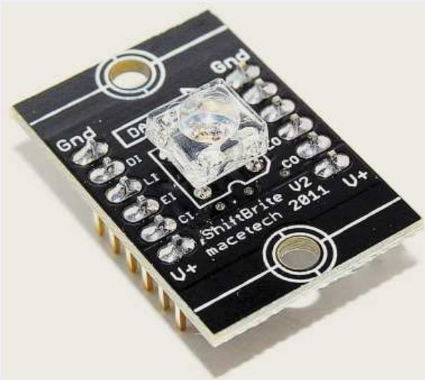
**Рис. 6.15.** Плата «ShiftBrite» обслуживает один RGB-светодиод
