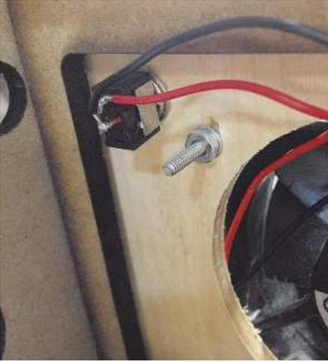
**Рис. 13.15.** Тумблер включает и выключает машинку для пузырей
