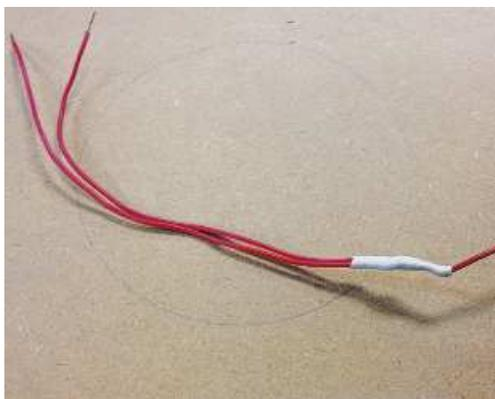
**Рис. 9.7.** Сращенные провода
