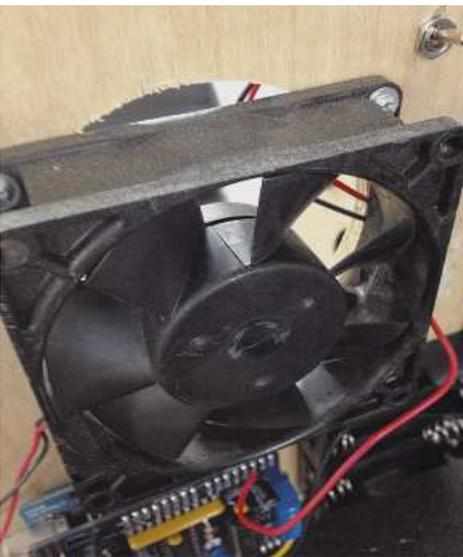
**Рис. 13.16.** Прикрепите кулер к задней панели корпуса
