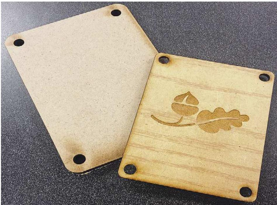
**Рис. 4.18.** Я использовал лазер для вырезания боковин
