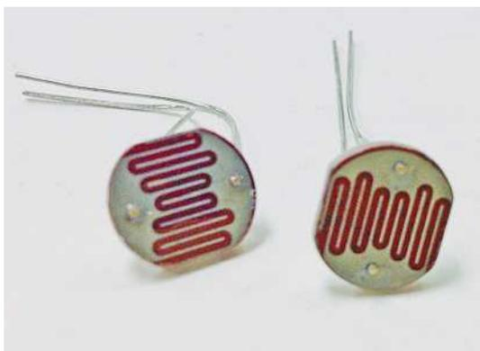
**Рис. 1.18.** Датчики передают Arduino информацию о степени освещенности
