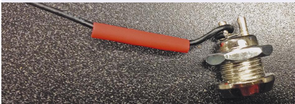
**Рис. 2.13.** Обмотайте провод вокруг одного из выводов
