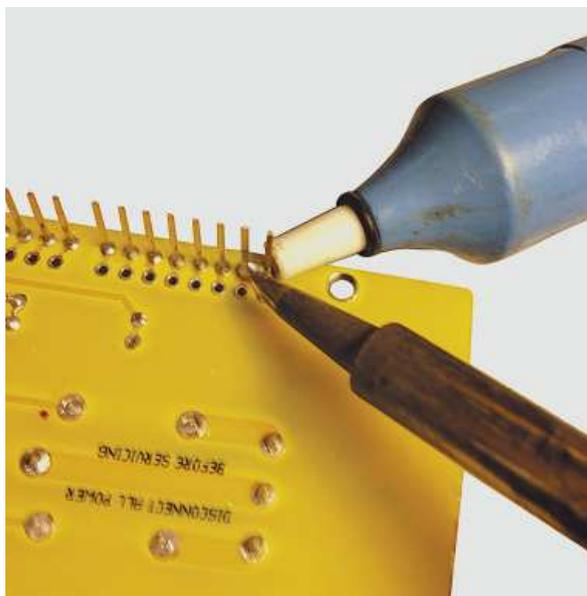
**Рис. 3.21.** Нагрейте неудачную пайку и удалите расплавленный металл!
