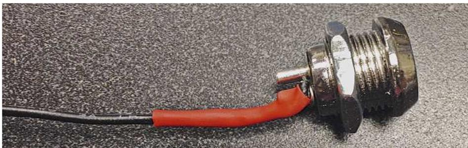
**Рис. 2.14.** Закрепите провод с помощью термоусаживаемой трубки
