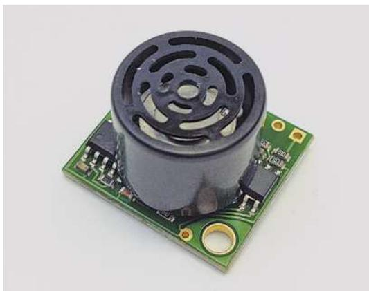
**Рис. 1.19.** Ультразвуковой датчик работает как радар
