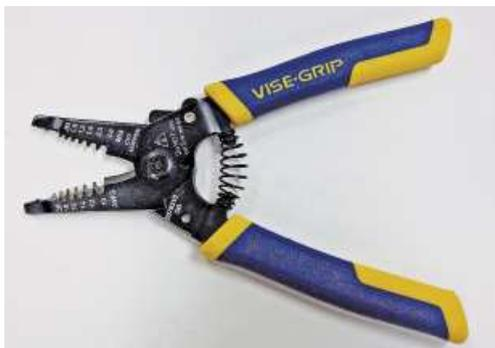
**Рис. 8.10.** Режьте провода и очищайте их от изоляции с помощью этого инструмента
