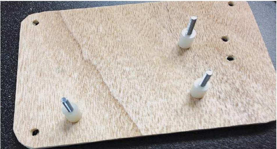
**Рис. 10.11.** Вкрутите болты в просверленные отверстия
