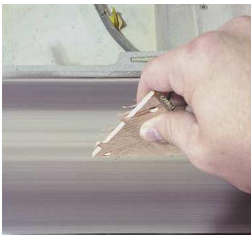
**Рис. 11.10.** Уберите неровности на шлифовальном станке
