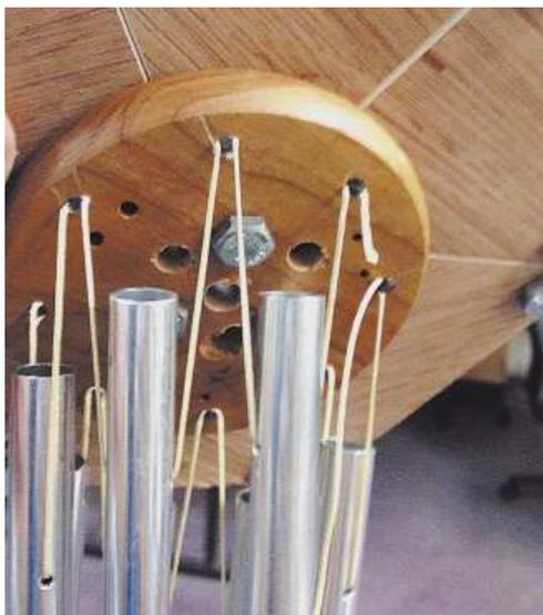
**Рис. 11.14.** Просверлите семь отверстий в верхней части китайских колокольчиков и прикрепите их к днищу корпуса
