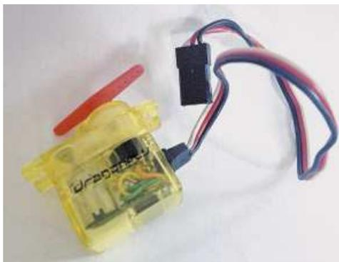
**Рис. 6.7.** Самодельный сервопривод передает данные через белый провод
