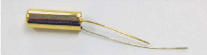
**Рис. 6.12.** Датчик звука, извлеченный из сломанной игрушки
