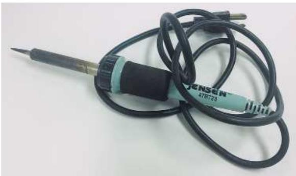
**Рис. 3.3.** Паяльник-ручка — отличный выбор для начинающего монтажника
