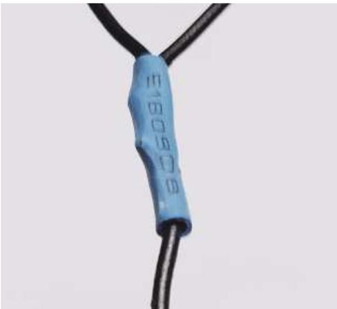
**Рис. 10.19.** Объедините заземляющие провода в один
