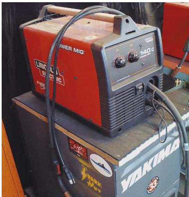
**Рис. 8.32.** Аппарат для МИГ-сварки
