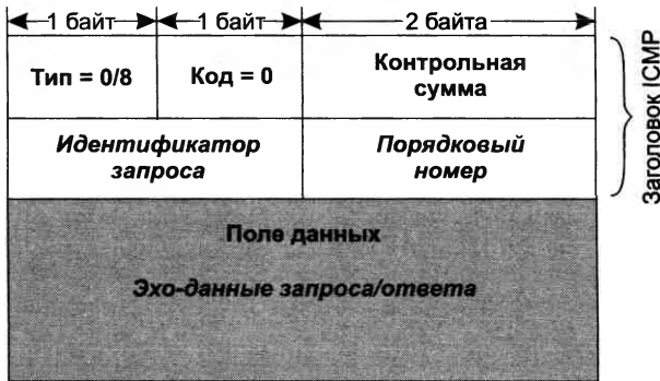
Рис. 15.24. Формат ICMP-сообщений типа эхо-запрос и эхо-ответ
