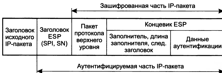
Рис. 29.19. Структура IP-пакета, обработанного протоколом ESP в транспортном режиме
