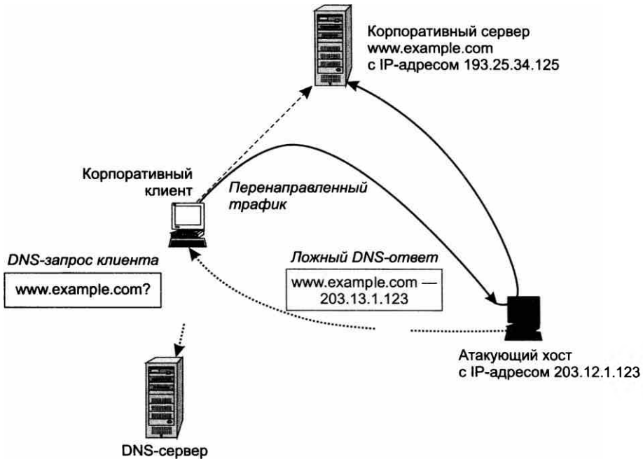
Рис. 29.5. Схема перенаправления трафика путем использования ложных DNS-ответов
