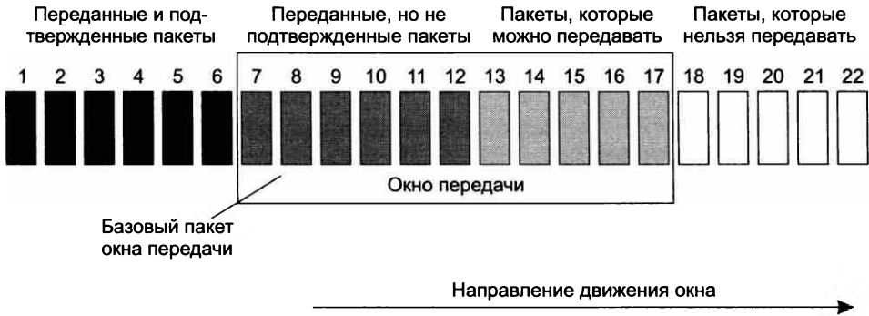
Рис. 16.13. Окно передачи в методе с возвратом на N пакетов
