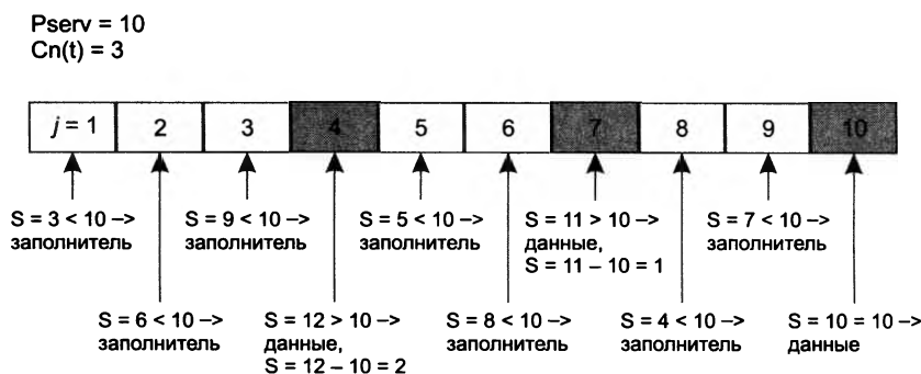
Рис. 10.20. Пример работы алгоритма «Сигма/Дельта»
