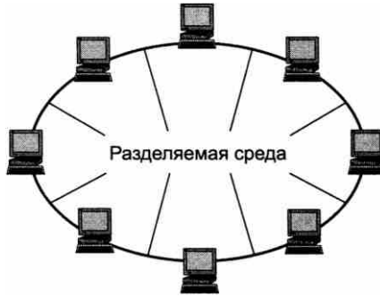
Рис. 11.2. Разделяемая среда в кольцевых топологиях
