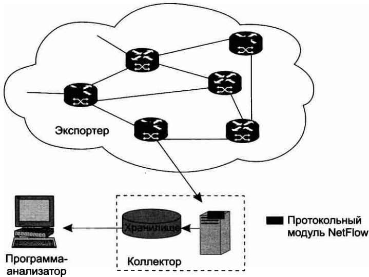
Рис. 28.10. Типичная система мониторинга на базе NetFlow
