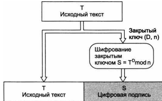
Рис. 27.7. Схема формирования цифровой подписи по алгоритму RSA
