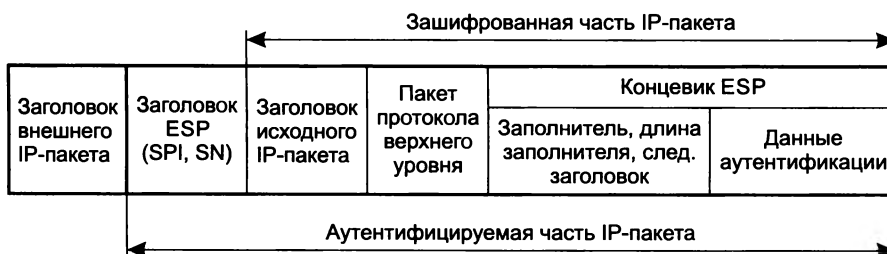
Рис. 29.20. Структура IP-пакета, обработанного протоколом ESP в туннельном режиме
