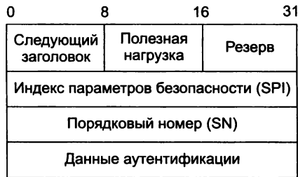
Рис. 29.16. Структура заголовка протокола АН
