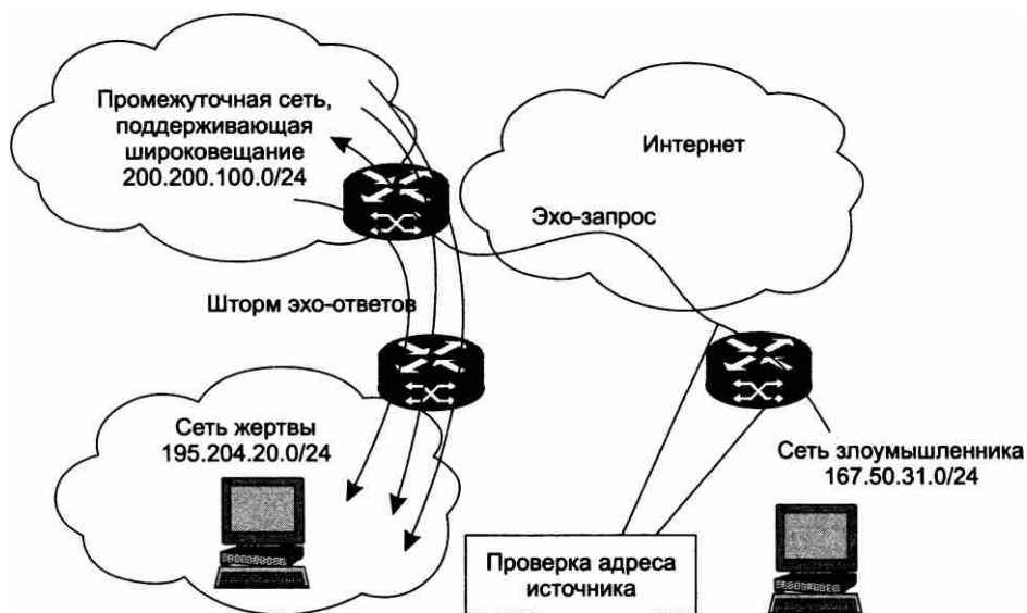
Рис. 29.4. Компоненты ICMP-атаки Smurf
