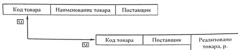
Рис. 2.10. Пример связи М:М
