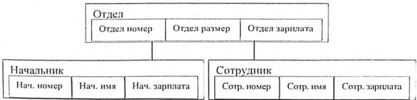
Рис. 2.2. Пример логической структуры иерархической БД
