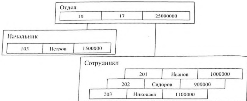
Рис. 2.3. Данные в иерархической базе
