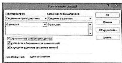
Рис. 6.15. Установление связей в БД: а) Окно «Схема данных», б) Окно диалога «Изменение связей»
