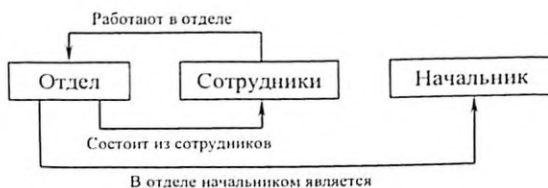
Рис. 2.5. Пример логической структуры сетевой БД
