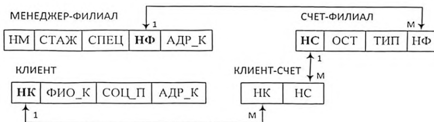
Рис. 3.7. Реляционная модель предметной области БАНК
