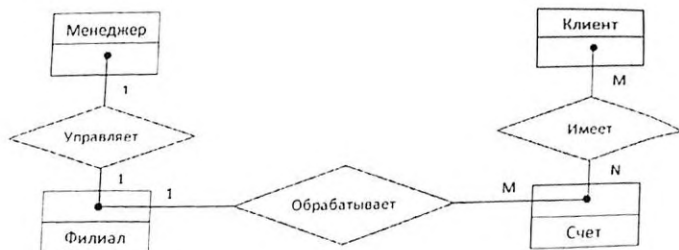
Рис. 3.5. Пример ER-модели предметной области БАНК
