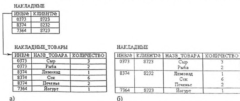
Рис. 2.11. Структуры данных: а) реляционная модель, б) постреляционная модель
