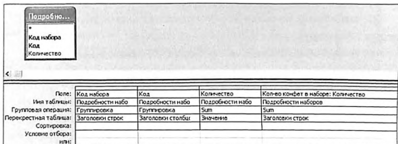
Рис. 6.25. Создание перекрестного запроса в режиме конструктора
