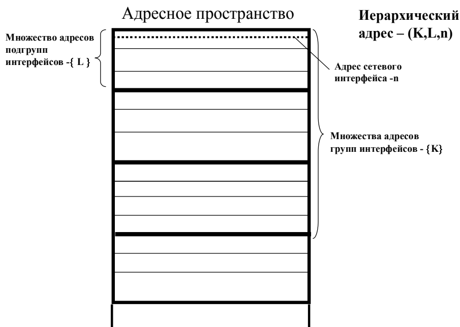
Рис. 2.11. Иерархическая структура адресного пространства
