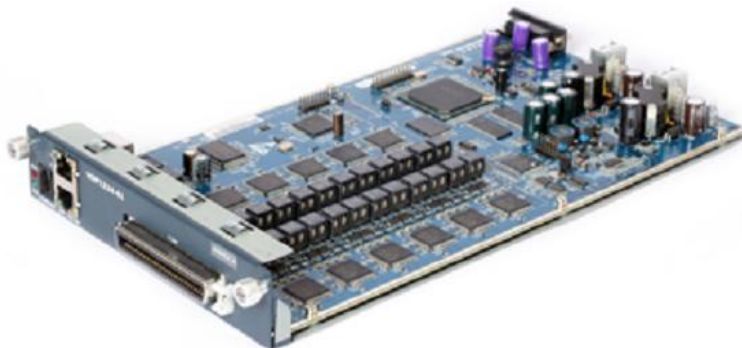
9.5-rasm. Telefoniya xizmatini taqdim etuvchi VOP1224 moduli
