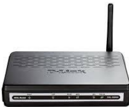
4.6-rasm. Wi-Fi texnologiyasini qo'llab-quvvatlovchi ADSL modem
