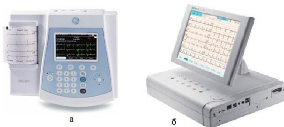
Рис.3.2. Электрокардиографы: а) портативный, б) стационарный
