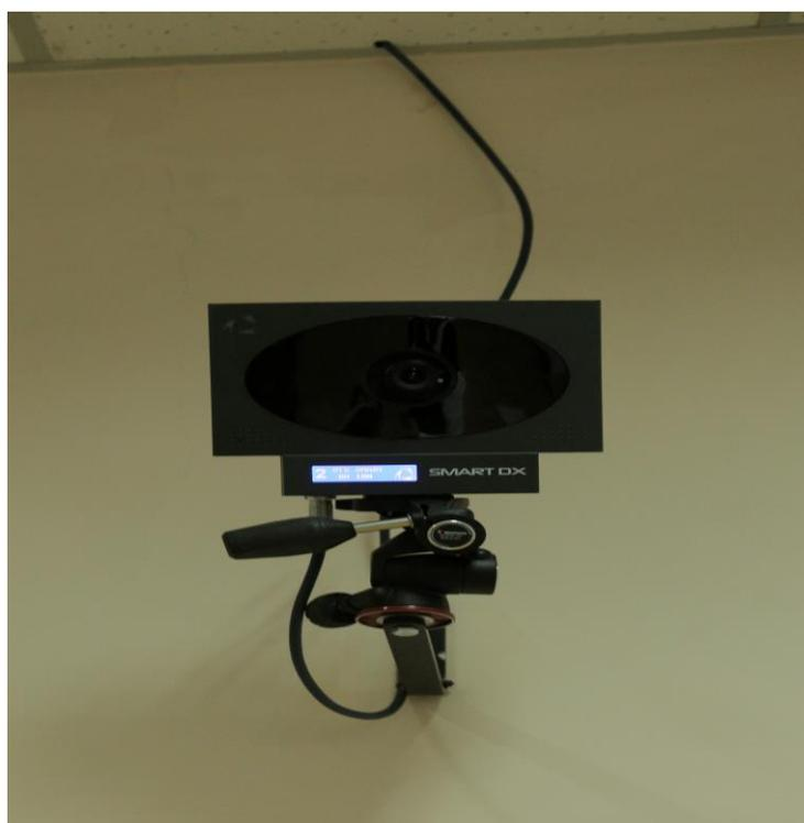
Рис.4.2,б. Инфракрасная камера наблюдения
