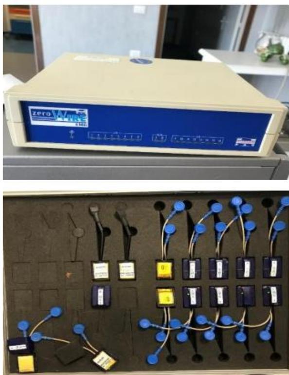
Рис.4.5. Комплект датчиков миограмм и процессор обработки
