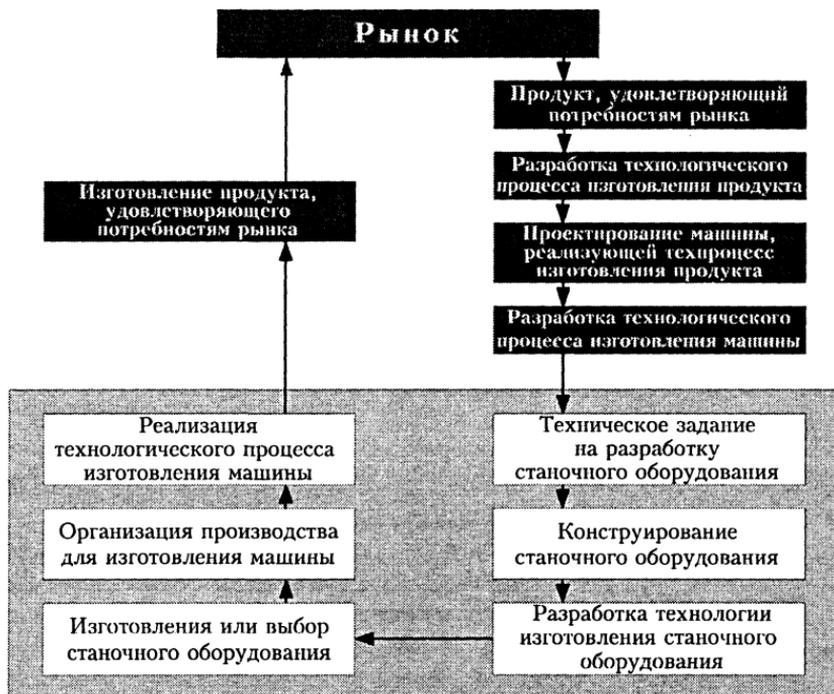
Рис.1.2. Модель расширенной производственной системы, замкнутой на рынок
