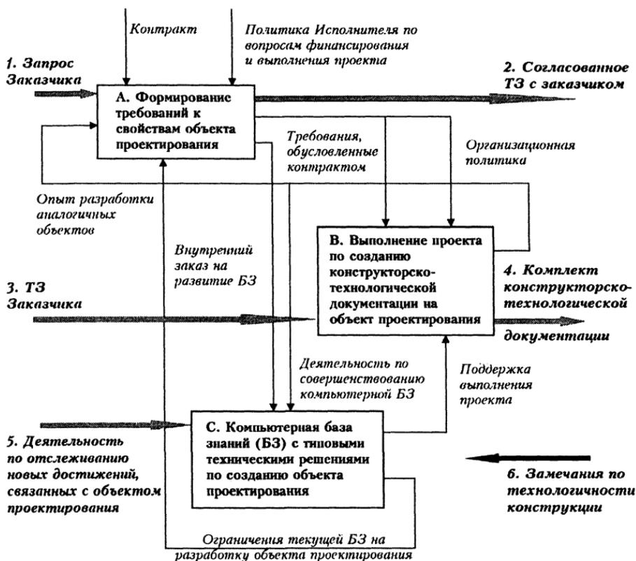
Рис.3.30. Укрупненная модель организации конструкторско-технологической подготовки производства для реализации индивидуального заказа
