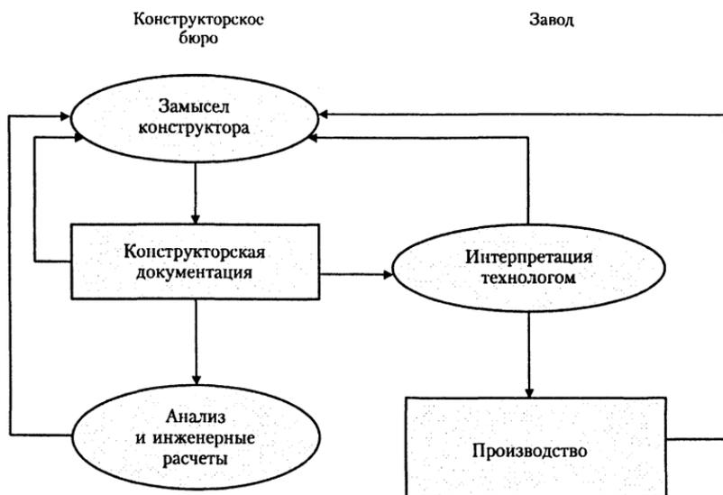
Рис.3.7. Традиционная организация проектирования и изготовления изделия в машиностроении
