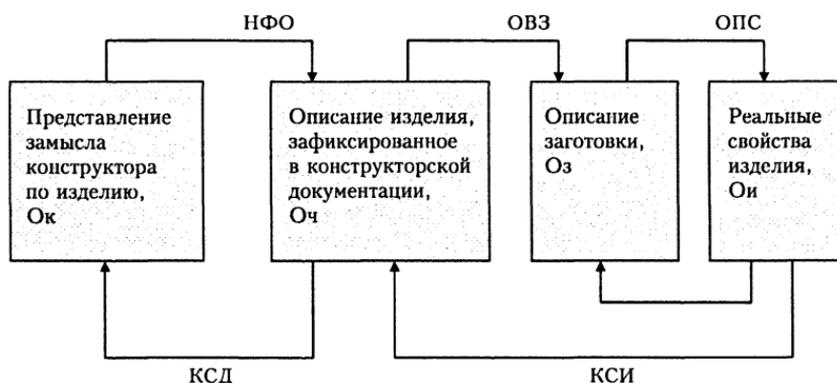
Рис.3.6. Жизненный цикл изделия от конструкторского замысла до воплощения и набор операций, его обеспечивающий.
