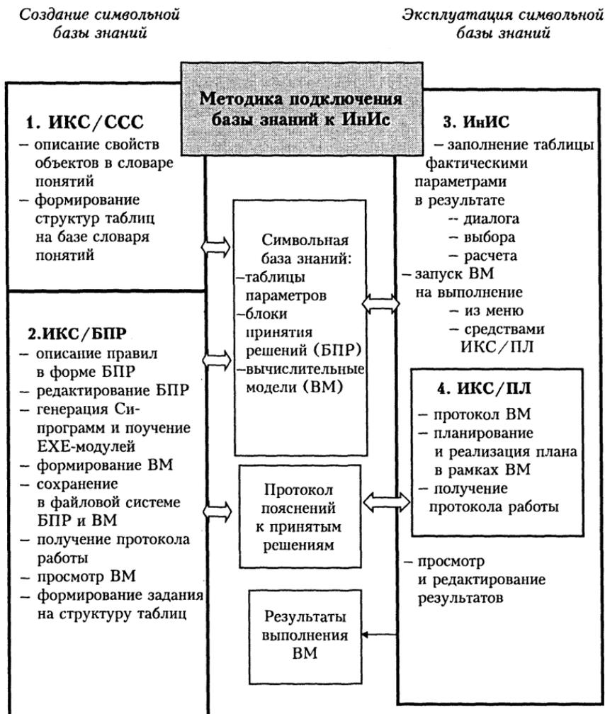
Рис.3.22. Взаимосвязь отдельных компонент ИКС и ИнИС в ходе создания и эксплуатации символьных баз знаний
