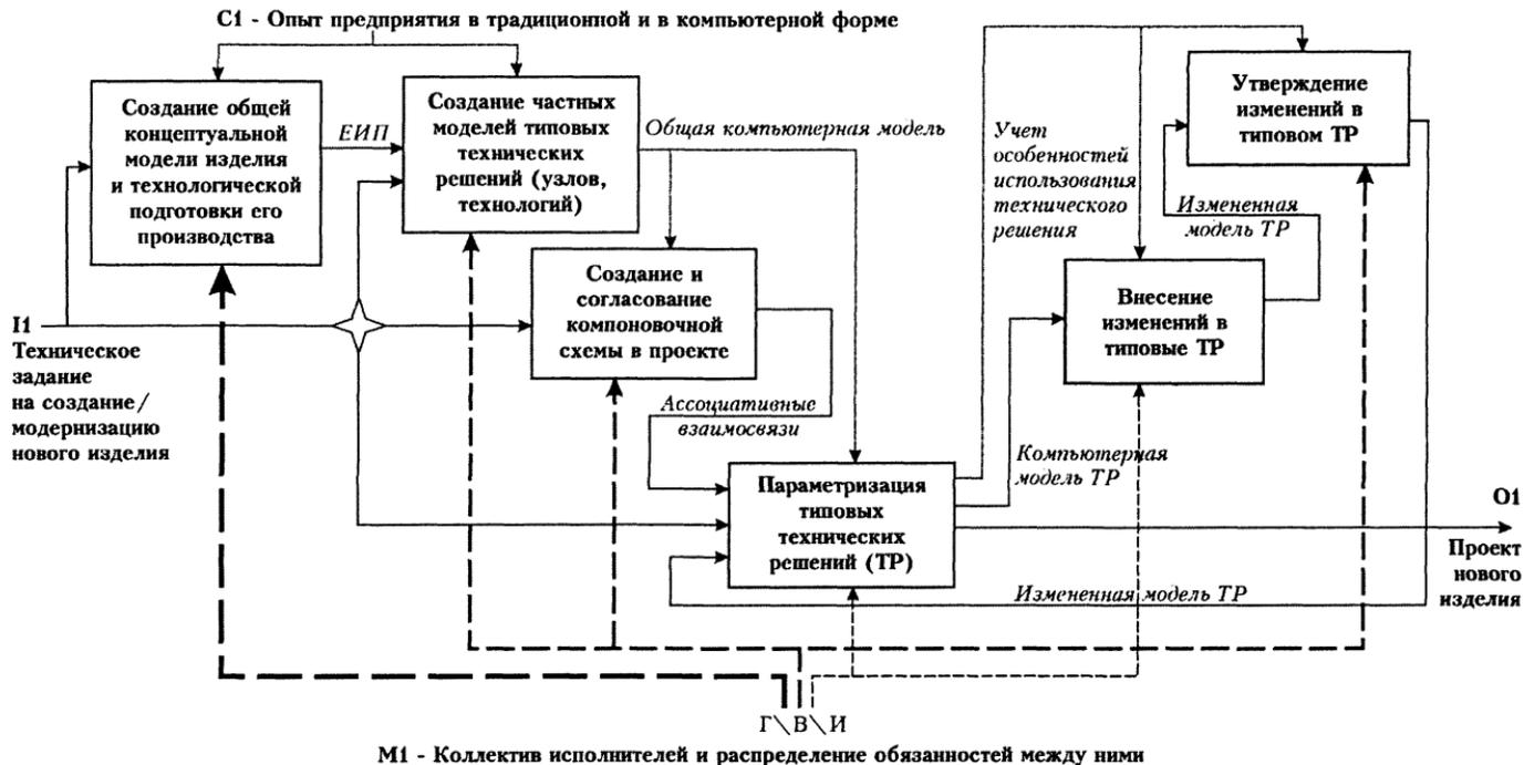
Рис.3.31. Пошаговая стратегия разработки решений при проектировании изделий машиностроения с использованием информационных технологий. *Используемые сокращения:* ЕИП – единое информационное пространство; Γ – главный конструктор; В – ведущие разработчики технических решений (ТР) проекта; И – исполнители проекта
