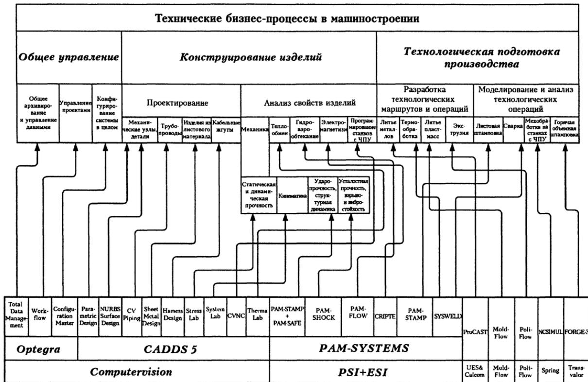
Рис.1.6. Решение инженерных задач на рабочих станциях (платформа UNIX)
