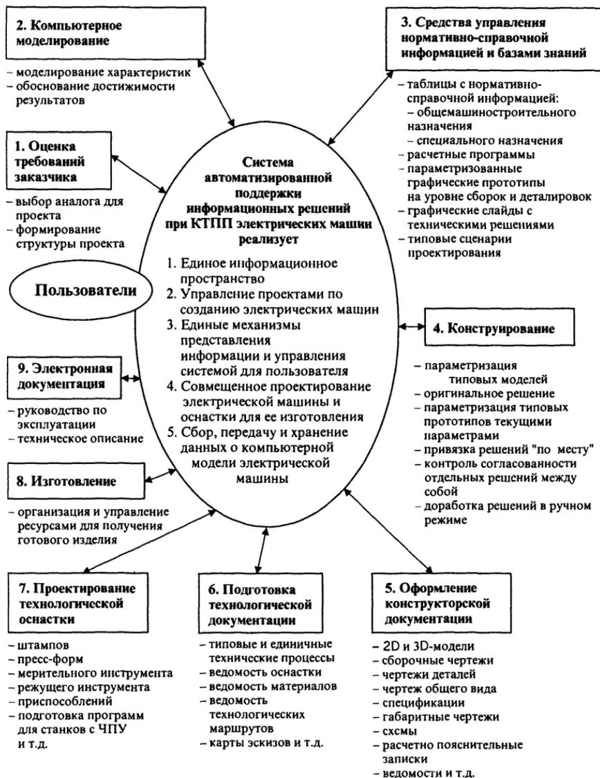
Рис.3.32. Задачи, решаемые в компьютерной среде при проектировании и изготовлении электрических машин по индивидуальному заказу
