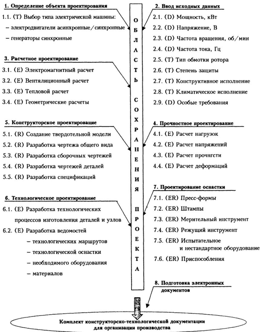
Рис.3.35. Возможности пользователя при проектировании электрической машины на основе единого информационного пространства.
