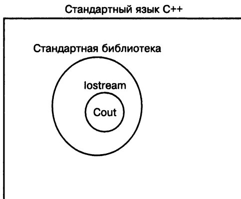
Рис. 1.3. В стандартной реализации языка C++ имеется набор файлов, называемый «стандартная библиотека». В стандартной библиотеке есть файл iostream , в котором определяются различные сущности, в том числе объект cout
