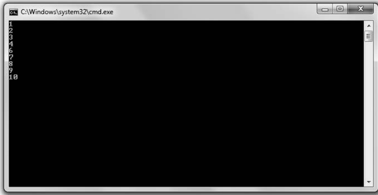
Рис. 2.8. Цифра 5 пропускается с помощью инструкции continue , цикл завершается инструкцией break (опубликовано с разрешения компании Microsoft)
