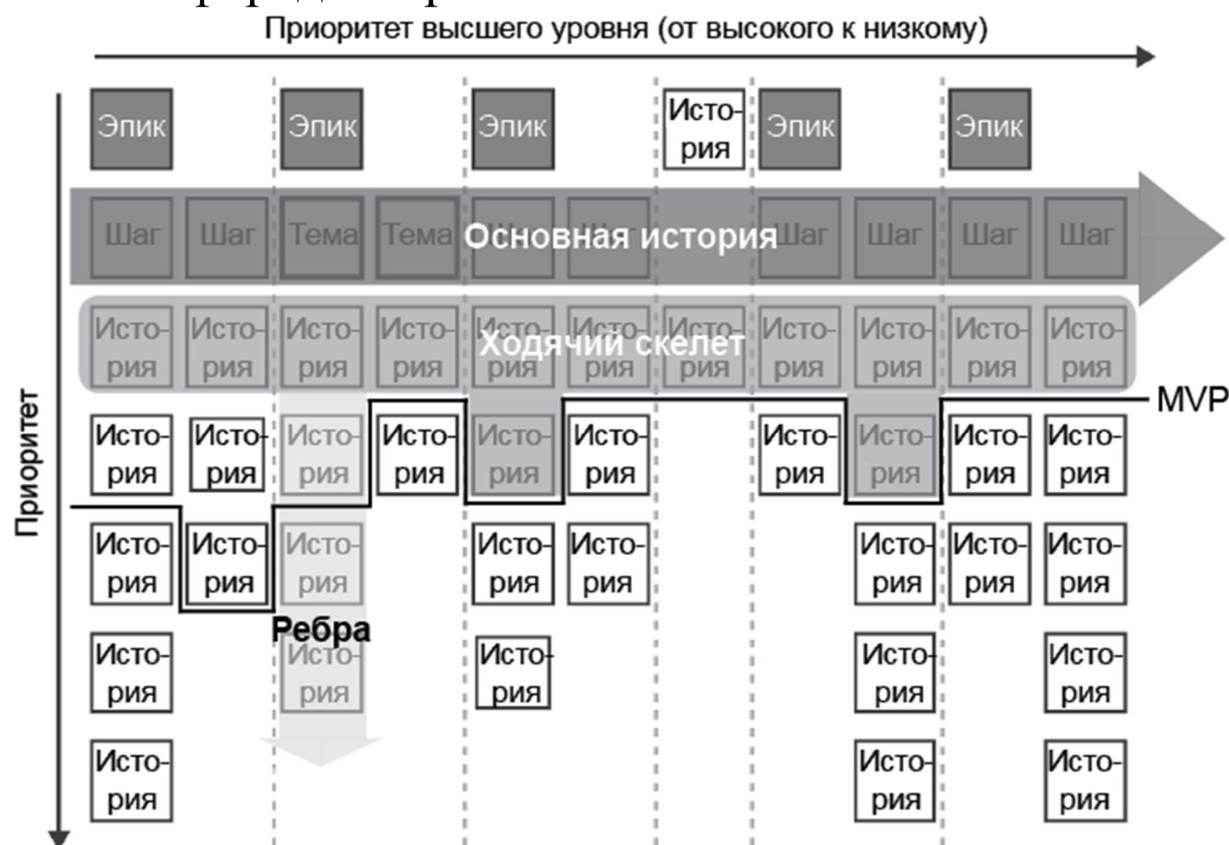
Рис. 14.4. Горизонтальный срез функциональности непосредственно под основной историей составляет минимальную целостную реализацию, называемую «ходячим скелетом». MVP обычно представляет собой нечто большее, чем ходячий скелет
