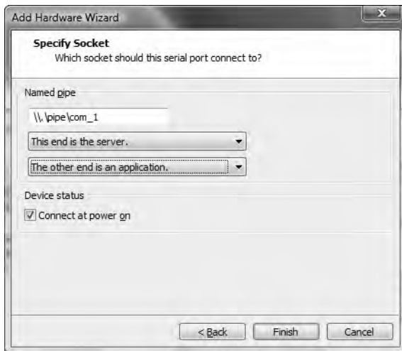
Рис. В.2. Настройки именованного канала
