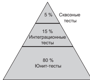
Рис. 11.3. Версия пирамиды тестирования Майка Кона 1 ; доли тестов в процентах и их состав в разных командах будут немного отличаться
