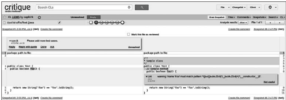
Рис. 20.1. Средство просмотра различий в Critique, отображающее панели с предупреждениями, сгенерированными платформой статического анализа Tricorder
