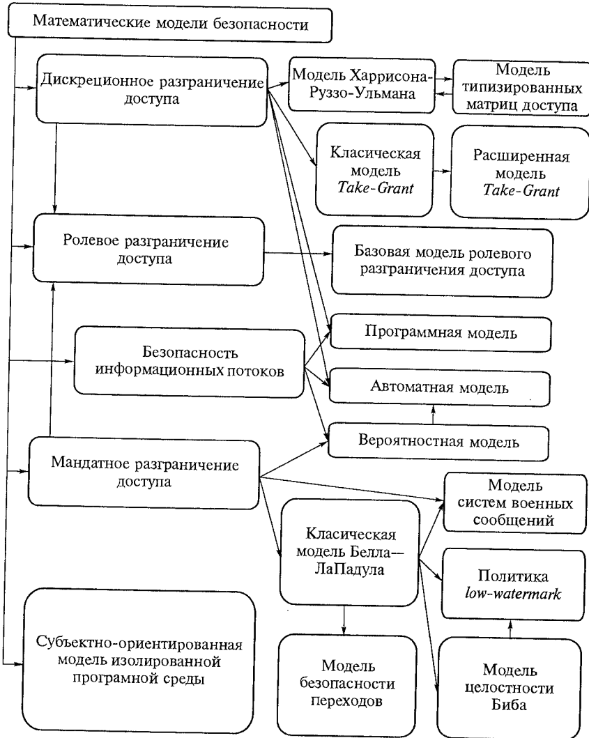
Рис. 1.7. Схема классификации и взаимосвязи положений математических моделей безопасности компьютерных систем
