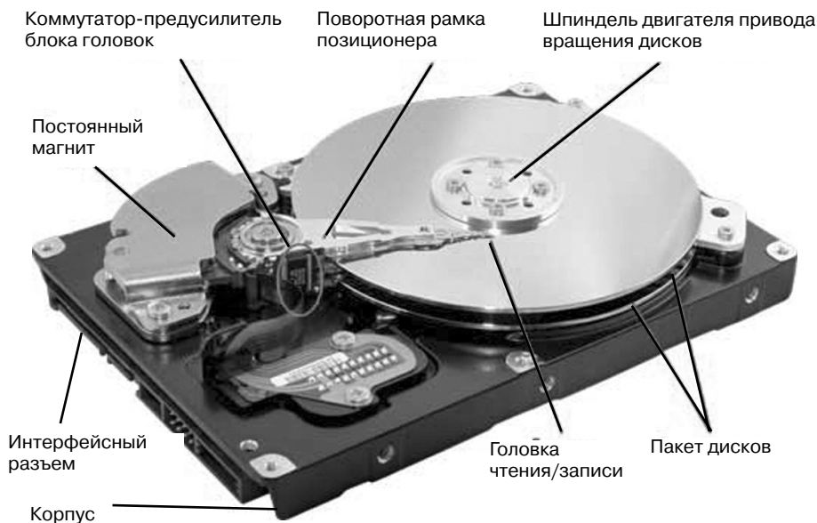
Рис. 1.1. Жесткий диск изнутри
