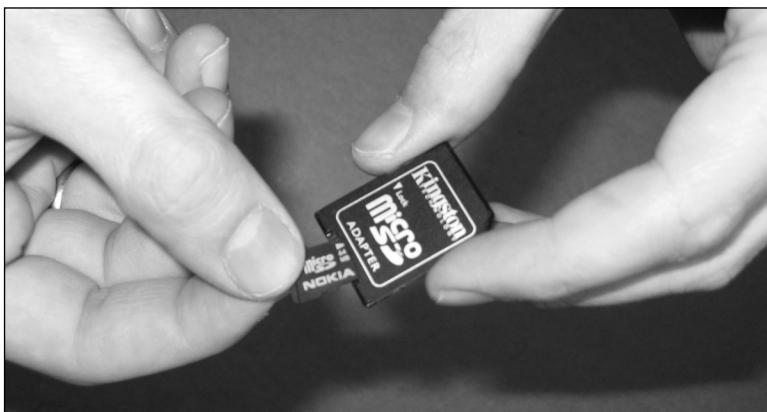
Рис. 7.11. Вставляем карту в переходник
