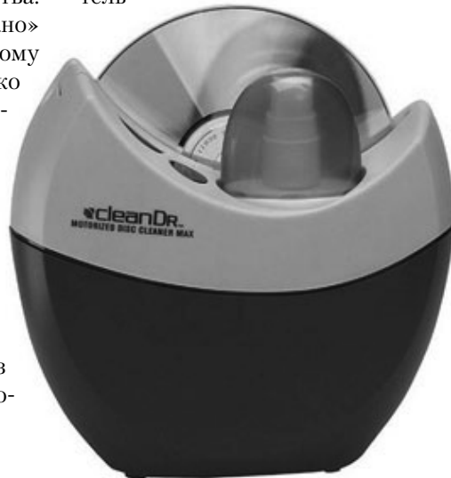
Рис. 6.11. CleanerDR — чистка диска. /Принцип работы устройства - полировка поверхности компакт-диска. С диска снимается верхний слой пластика, в результате чего царапины либо исчезают вовсе, либо становятся менее глубокими, что уменьшает преломление лазерного луча и восстанавливает "читабельность" диска. Самое интересное, что цена этого устройства совсем невелика - всего лишь $20. Если оно действительно работает именно так, как заявлено, то такую штуку должен иметь дома каждый [8]
