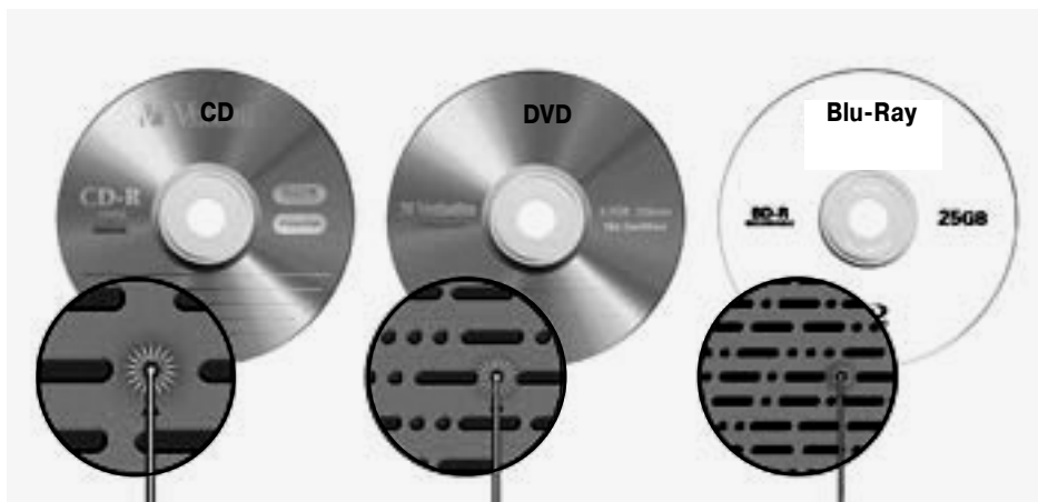
Рис. 6.8. Изменение плотности размещения данных на Blu-Ray-диске по сравнению с CD и DVD (взято на www.karinaplus.ru )
